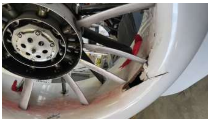
Photo : dommage sur le fenestron
